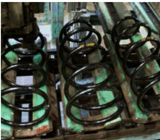
Ressorts de suspension automobile avec repères colorés.
